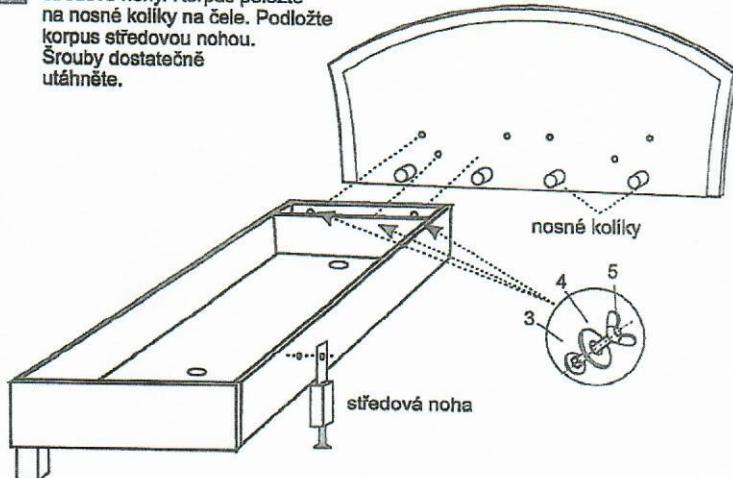
**3** Montáž druhého korpusu k čelu. Spojení korpusů se středovou nožkou šroubem č. 2. Větrací mřížky č. 6. Dotažení všech šroubů !!!
